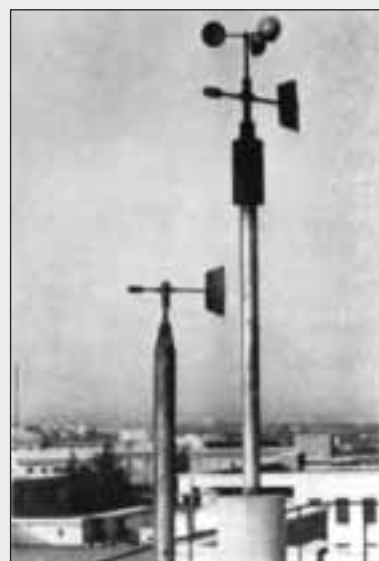
Figura 5 Anemografi installati sulla terrazza dell'Istituto di Fisica a Roma Fonte: Istituto Nazionale di Geofisica, supplemento alla rivista "Annali di Geofisica", Roma, 1949
