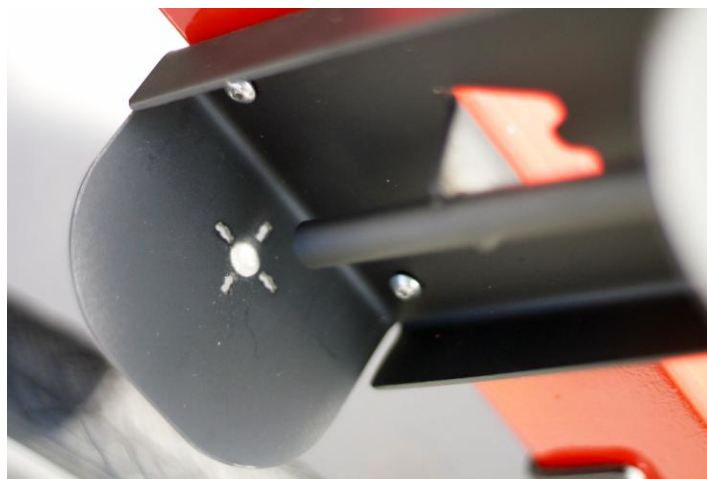
Fig. 3 – Il “collimatore solare” per il corretto posizionamento dell’Eliopompa.
